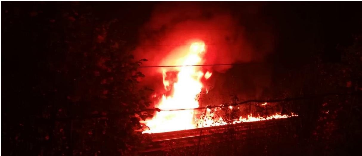
Abb. 11: ICE-Brand bei Montabaur am 12.10.2018. Vollbrand 7 Minuten nach dem auslösenden Kurzschluss und 4 Minuten nach Halt des Zuges. Die Flammen schlagen bis zum Waggondach. 16
